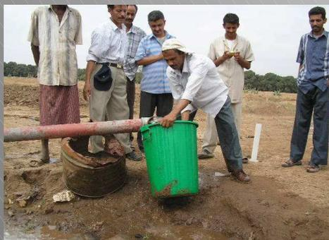
La mesure du débit du forage de l'exploitation
