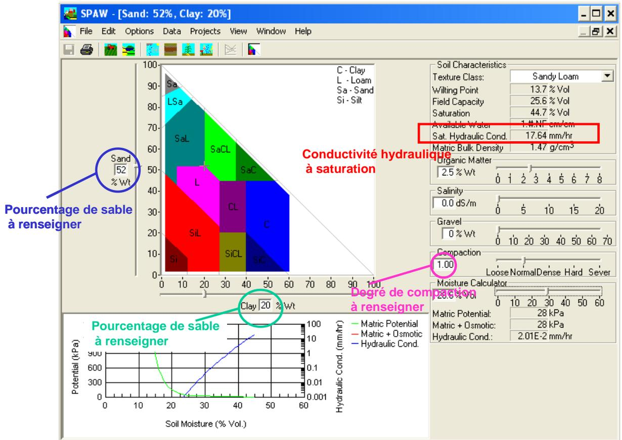
Figure 14 : Interface du module « Soil Water Characteristics » pour la détermination de la conductivité hydraulique à saturation.
