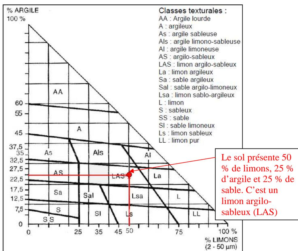
Figure 51. Diagramme des textures du GEPPA (Baize, 1995).
