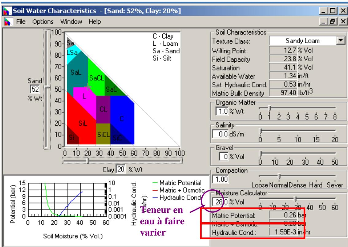
**Figure 25. Interface du module « Soil Water Characteristics » pour déterminer la pression matricielle et la conductivité hydraulique en fonction de la teneur en eau du sol.**
