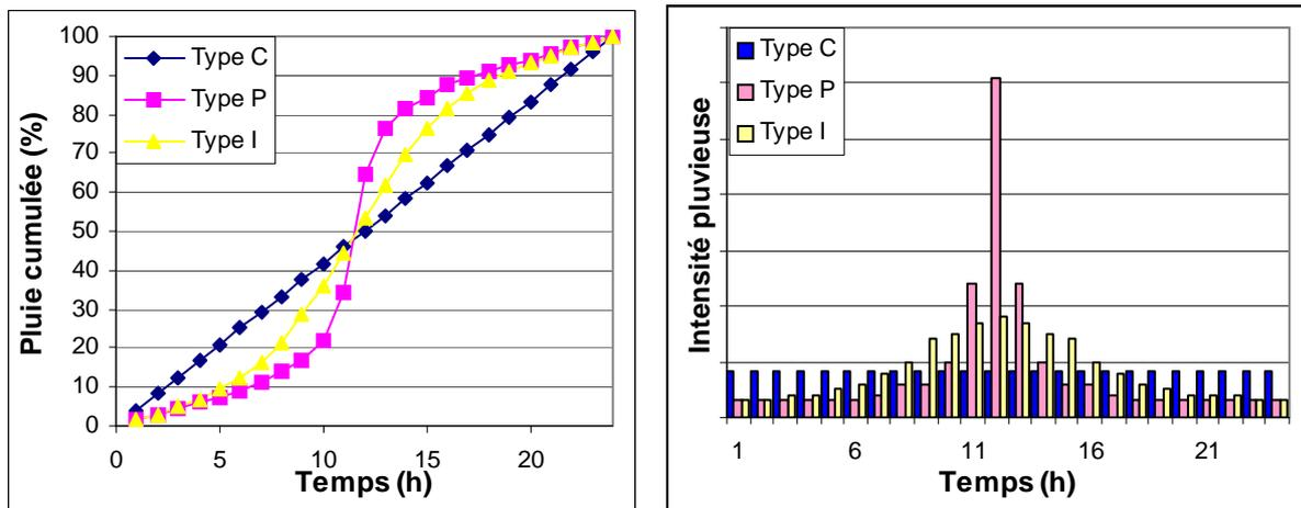
Figure 56. Formes cumulée et non cumulée des types de hyetogramme proposés à l'utilisateur.
