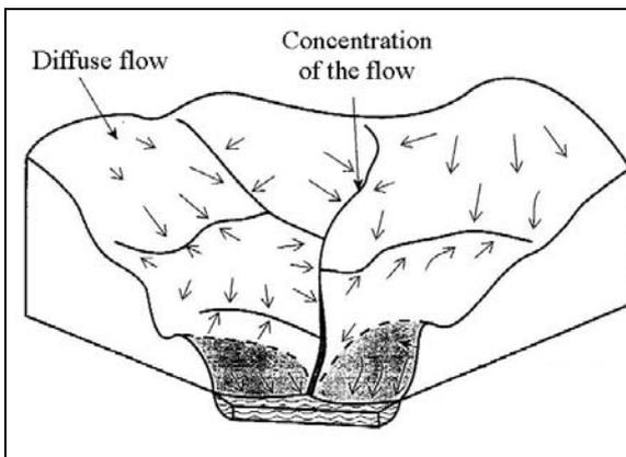
Figure 4. Concentration du ruissellement au sein d'un bassin versant (CORPEN, 2007).
