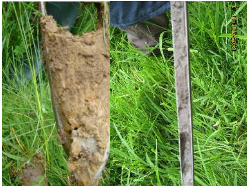
7. Pseudogley (hydromorphie temporaire : fond gris et tâches de rouille) à gauche et sol détrempe à droite
