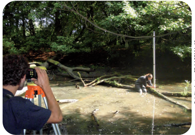
Réalisation d'un profil topographique. Cette démarche est détaillée dans la fiche technique n°1
