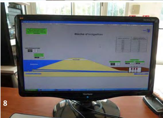
5) Mise en pression du réseau d'irrigation. 6) Débitmètre de suivi instantané et cumulé des eaux consommées pour l'irrigation : prélèvement en cours pour l'irrigation à environ 60 m<sup>3</sup>/h. 7) Panneau de la station de pompage. 8) Synoptique de suivi du fonctionnement de la lagune de stockage par Veolia : débit en entrée, niveau d'eau dans le bassin, débit pompé, pression dans le réseau.
