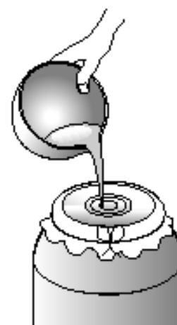
Figure 5 : Le tamisage de l'eau sur un tissu
