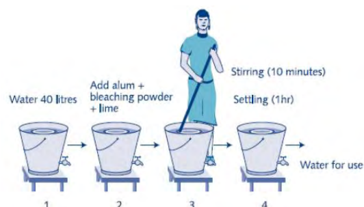
Figure 14 : Schéma d'utilisation de la technique Nalgonda pour le traitement du fluor
