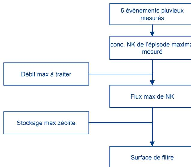
**FIGURE 18 : DIMENSIONNEMENT DU FILTRE POUR UNE NITRIFICATION COMPLÈTE**
