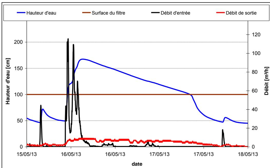
FIGURE 5 : EXEMPLE DE L'HYDRAULIQUE DU FILTRE DE MARCY L'ÉTOILE (SURFACE 250 M<sup>2</sup>) LORS D'UN ÉVÈNEMENT PLUVIEUX
