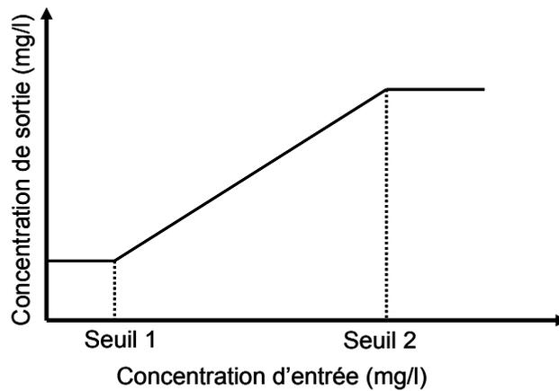
**FIGURE 7 : RELATION ENTRE CONCENTRATIONS D'ENTRÉE ET DE SORTIE**
