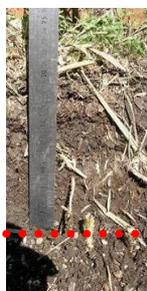
Il convient d'enlever le **maximum** de boue en surface des filtres tout en prenant garde de **préserver** la couche filtrante de surface. Après plusieurs années d'utilisation, la couche de gravier de surface est mélangée avec la boue, il faut donc être vigilant au changement de texture pour voir à quelle profondeur s'arrêter de curer. Il convient donc de s'arrêter de curer à la profondeur d'apparition des premiers gravillons (Figure 9).
