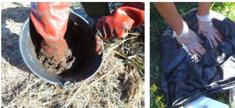
Figure 6 – Homogénéisation de l'échantillon moyen, dans un seau ou à travers un sac plastique
