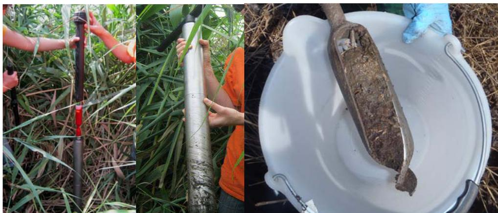
Figure 8 Prélèvement de boue à l'aide d'un carottier (photos de gauche), d'une tarière (photo de droite)
