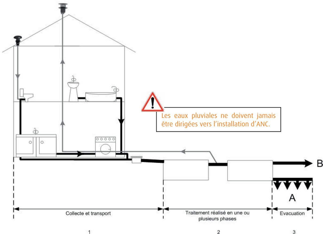
1) La collecte et le transport des eaux usées en sortie d'habitation sont réalisés d'une part par des dispositifs de collecte (boîtes plus souvent appelées regards), puis par des canalisations ;
