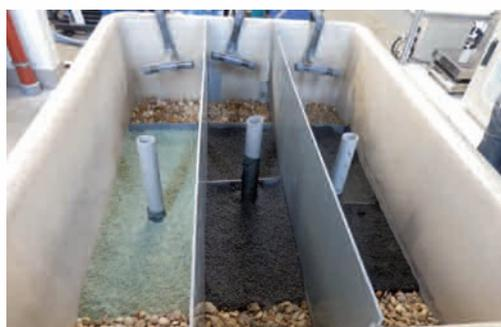
**Figure 2.** Pilotes garnis de matériaux adsorbants (argile expansée, zéolite et charbon actif).
