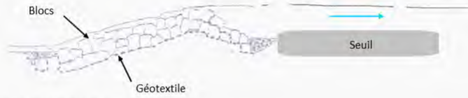
Rampe en enrochement
