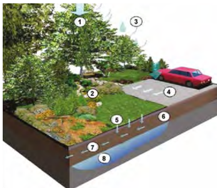
Figure 8 : Les différentes variables hydrologiques dans le concept d'«aménagement paysager absorbant» (Absorbent landscape, d'après les documents du Greater Vancouver Regional District)
