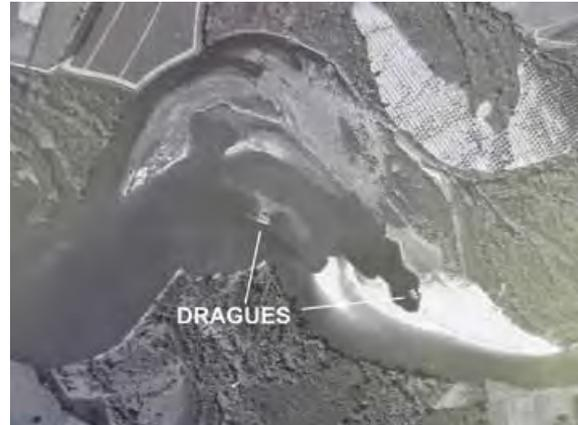
Figure 6. Exemples d'extractions de granulats en lit mineur.
