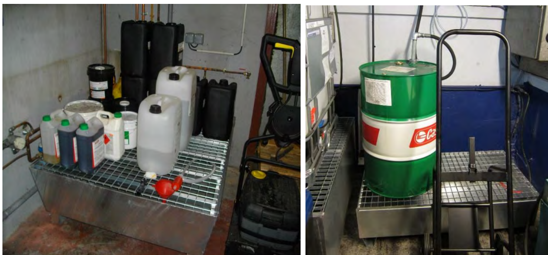
Dispositifs de rétention adaptés aux petits (à gauche) et grands (à droite) contenants - Source : Vienne Condrieu Agglomération
