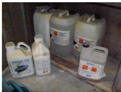
Stockage non conforme et non sécurisé de bidons et pots de peinture, de bidons d'acide chlorhydrique, d'acide fluoridrique, etc. - Source : Grand Chambéry
