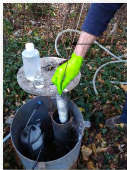
Fig. 31. Les chemcatcher, cylindres métalliques permettant de fixer les membranes (a) et mise en place dans un piézomètre (b) (© photos L.Pinasseau et Graie)
