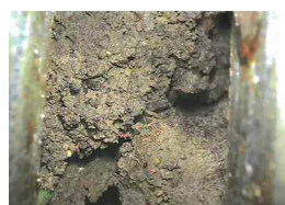
Photographie réalisée à l'aide d'un géoendoscope dans un forage de pénétromètre.
