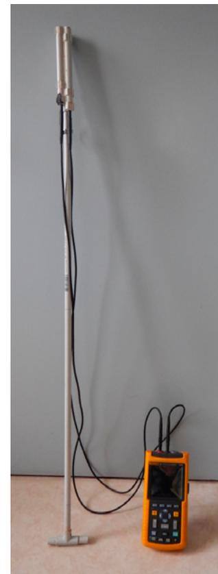
Figure 8. Sonde Penny reliée à un oscilloscope portable.
