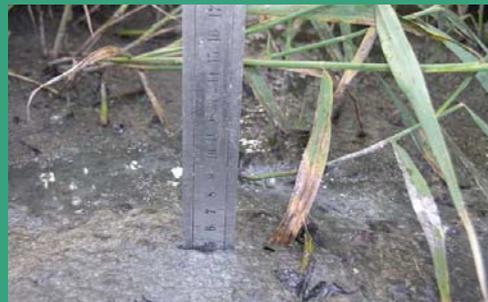
Mesure de la hauteur des boues accumulées
