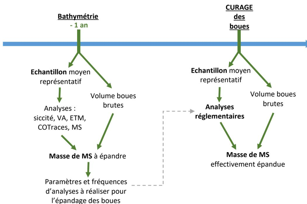
Pendant l'opération de curage, les volumes extraits sont comptabilisés généralement à l'aide du comptage des remplissages de citernes. Plusieurs prélèvements, réalisés régulièrement tout au long de l'opération de curage, constitueront l'échantillon composite pour analyses et connaissance à posteriori des masses extraites épandues.
