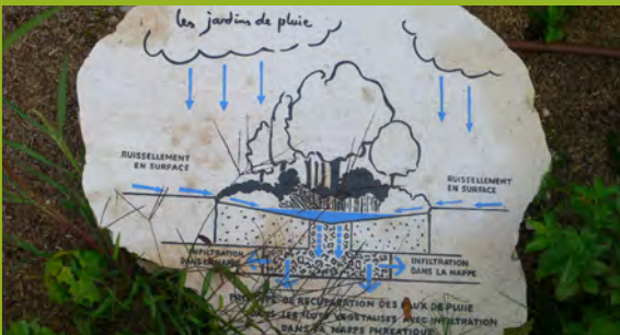
Support pédagogique présentant le fonctionnement des jardins de pluie présent sur le site (source: Municipalité de Saint-Martin-d'Hères)
