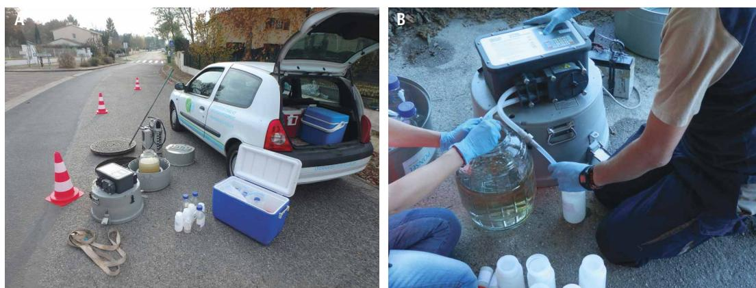
Pose de dispositif d'échantillonnage automatisé dans le regard d'assainissement d'un quartier pavillonnaire, et répartition du prélèvement après homogénéisation dans divers flacons destinés au laboratoire d'analyse. [Regard, 9]
