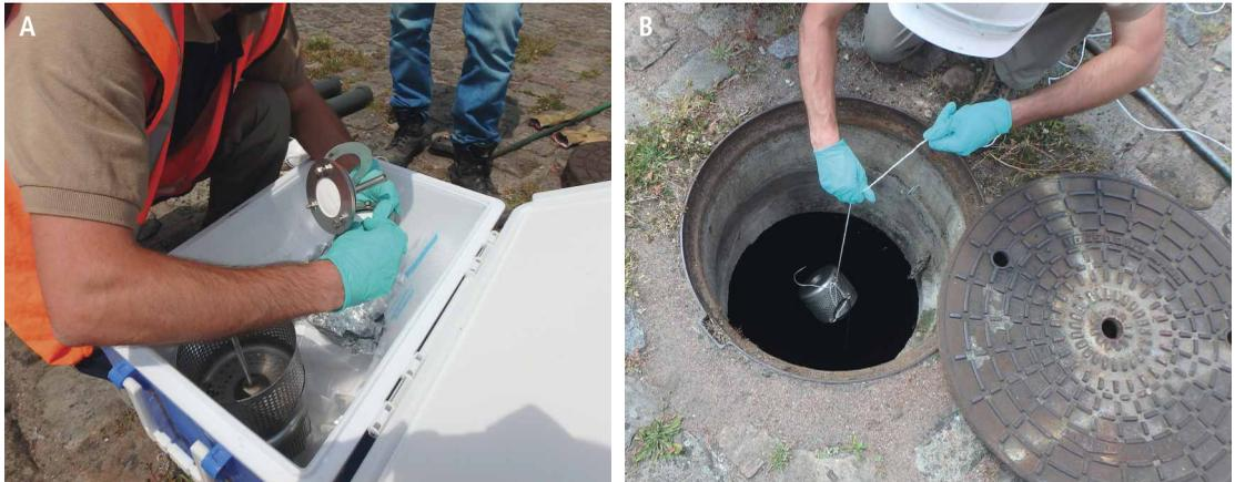
Illustration du montage, puis du déploiement en réseau d'échantillonneurs intégratifs de type POCIS [Regard, 9].
