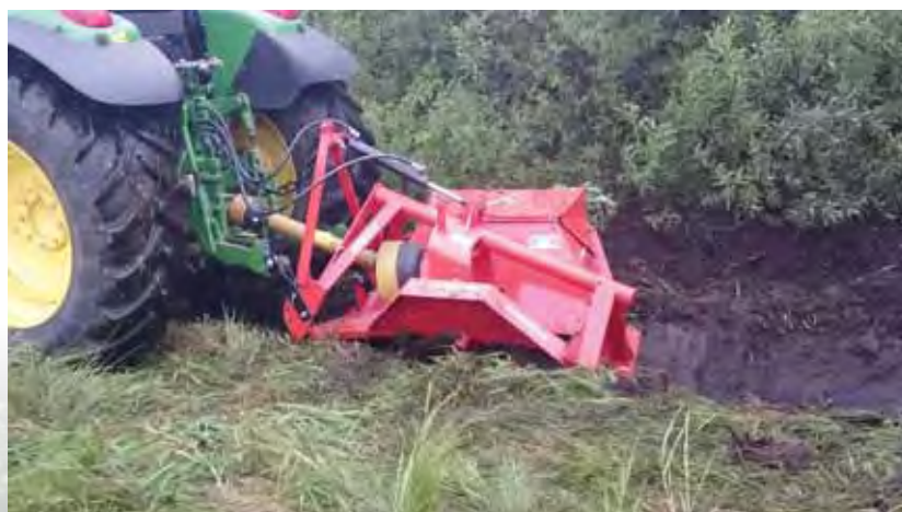
▲ Tracteur en zone humide équipé d'une rigoleuse.
