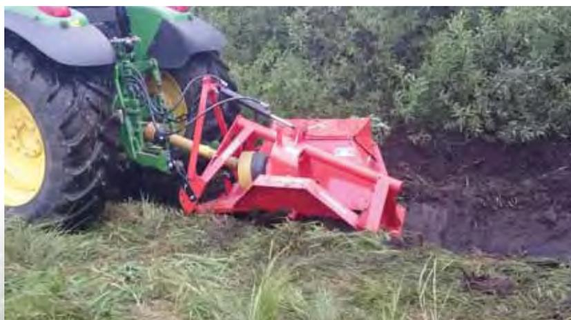
▲ Tracteur en zone humide équipé d'une rigoleuse.
