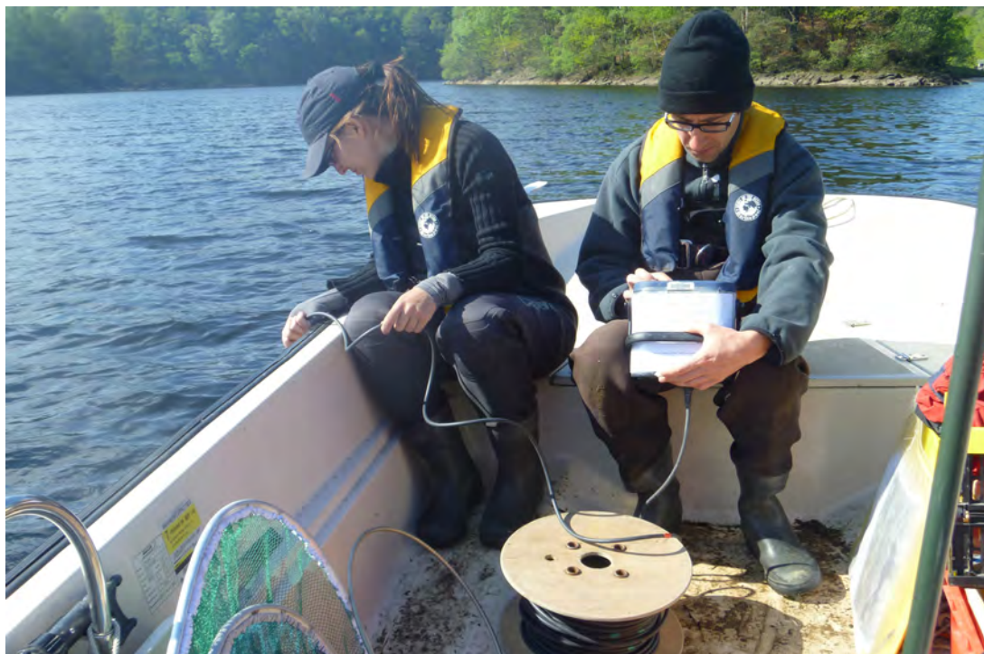
Mesures de profil température-oxygène dans la colonne d'eau sur la retenue des Barriousses. Les paramètres physico-chimiques étaient historiquement pris en compte pour l'évaluation de l'état écologique des masses d'eau. © Romain Roy.
