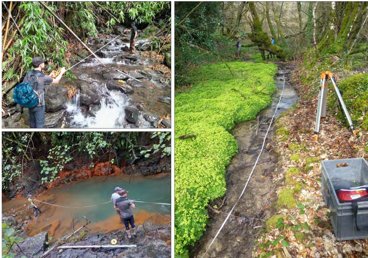
Figure 6 : La disposition d'un décimètre au long de la station permet de déterminer ses bornes amont et aval, et permettra également de repérer la position et de faciliter différentes mesures intégrant le périmètre du protocole ROHZACE (profils en travers, faciès, habitats aquatiques complémentaires, etc.). (© OFB)
