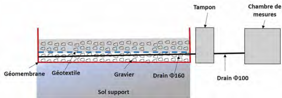
Figure 5. Coupe longitudinale de la tranchée.
