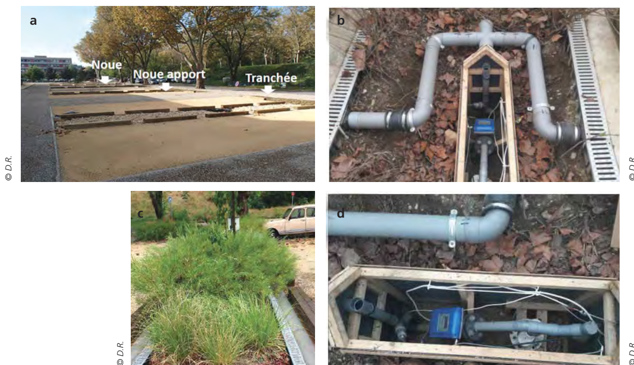
Figure 9. Système de mesure permettant d'évaluer les débits et volumes d'eau en entrée des systèmes drainés par la noue et la tranchée. a) montre la localisation et la similitude du site de référence, b) montre la noue de référence avec installation à la périphérie des caniveaux, c) et d) la connexion des caniveaux au système de mesure (double mesure 1/par auget basculant et 2/par mesure électromagnétique).
