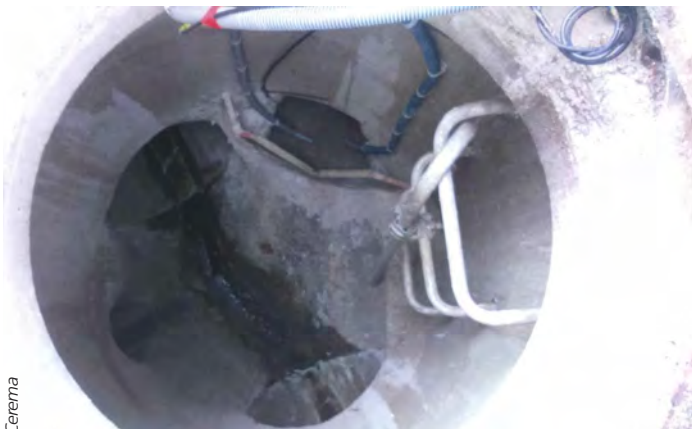
Figure 6. Déversoir en V avec mesure de la hauteur d'eau et du débit provenant du ruissellement issu du parking de référence.
