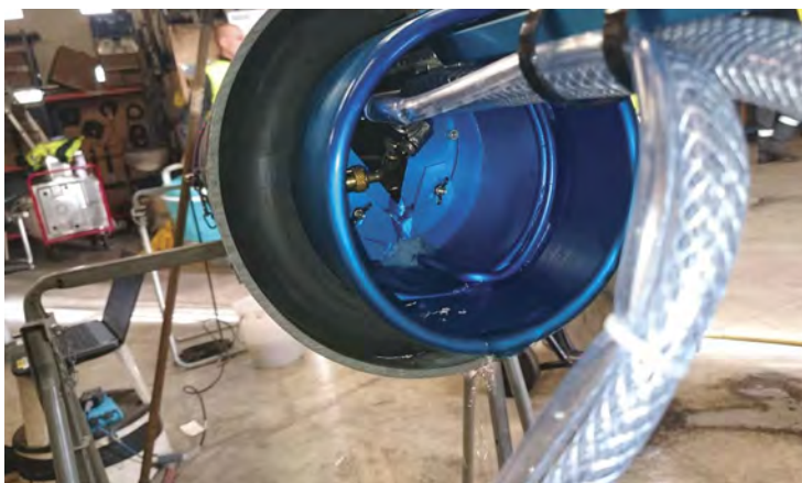
Figures 7 et 8. Obturateur déversoir employé pour mesurer le débit en sortie (aval des filtres et du vortex).
