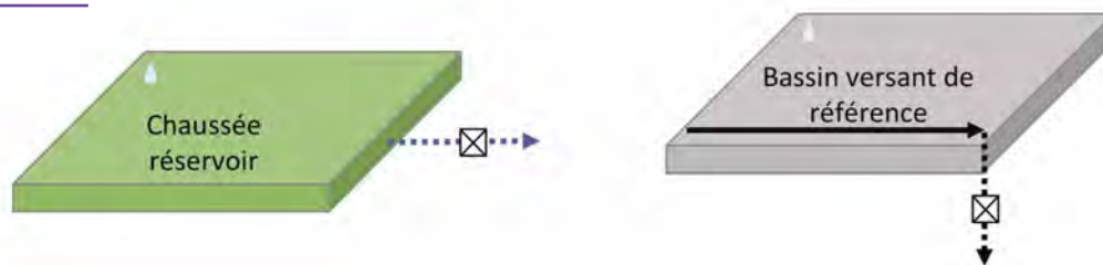
Figure 3. Schéma fonctionnel du site, le système étudié à gauche, la zone de référence pour les eaux brutes à droite.
