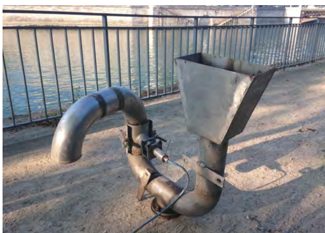
Figure 6. Siphon avec sonde Nivus.
