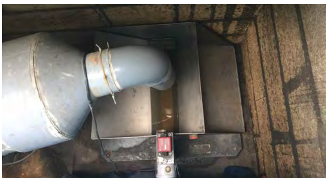
Figure 8. Auget basculant mesurant l'écoulement du ruissellement issu du bassin versant de référence.
