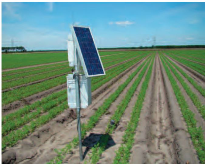
Sonde capacitive pour mesurer l'humidité du sol : pilotage fin d'irrigation - Gironde (France)
